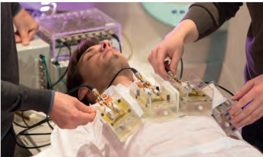
Die Sensoren für die Bildgebung des schlagenden Herzens wurden an der Berliner Ultrahochfeld-Anlage entwickelt. Mit den 32 Dipol-Antennen kann das Organ von allen Seiten erfasst werden.
